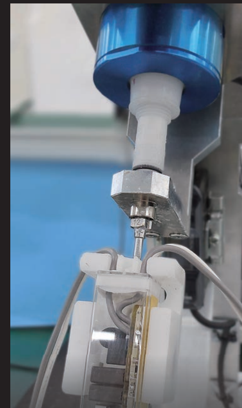
電源ユニットの樹脂注入 (100V/200V製品)
